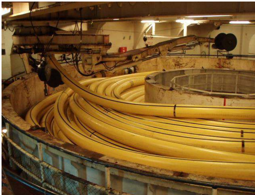
Figura 19: Cesta de armazenamento de linhas flexíveis
