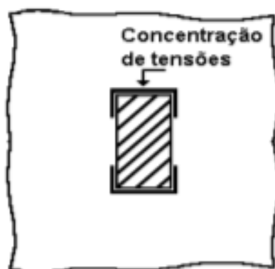
Figura 10 – Representação esquemática da concentração de tensões nos cantos e no menor lado de pilares alongados
