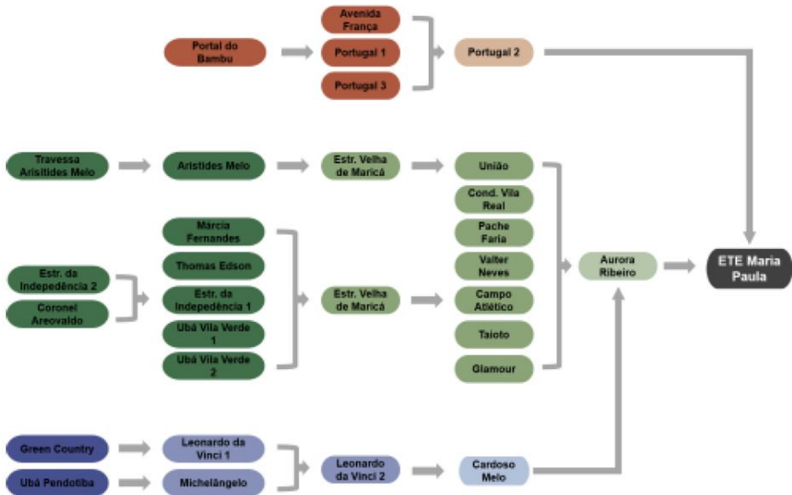
Figura 17: Fluxograma das estações elevatórias na Bacia Maria Paula, Niterói – RJ.
