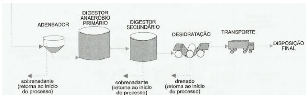
Figura 12: Fluxo de tratamento do lodo excedente.
