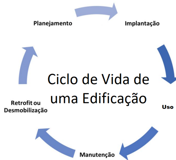
Figura 4: Ciclo de Vida de uma Edificação
