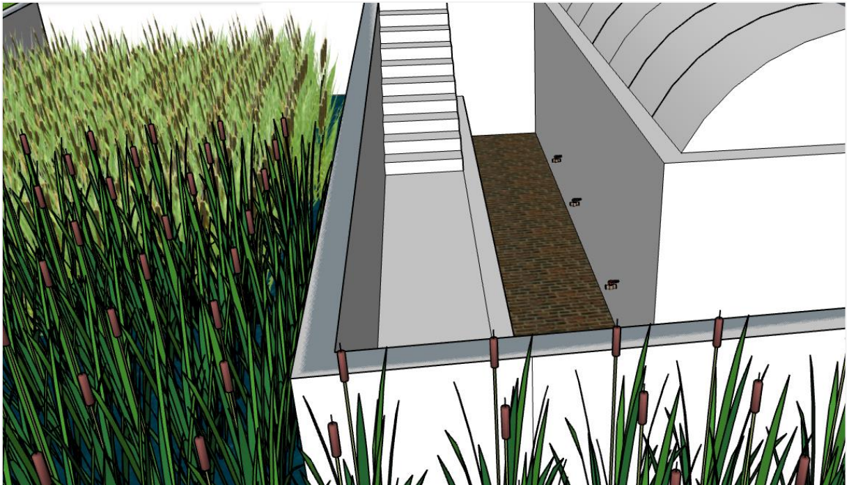
Figura 24: Projeto do BSI em 3D - Vista do Leito de Secagem e cobertura do biodigestor
