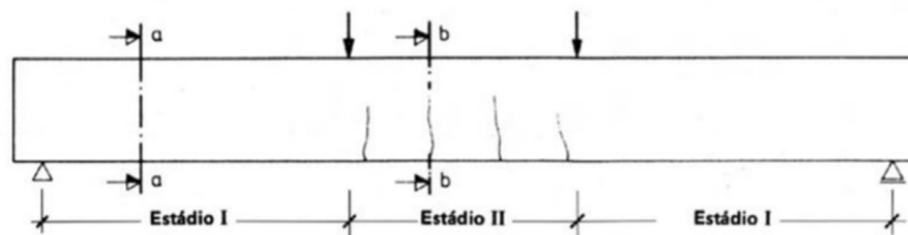
Figura 4 Aparecimento das fissuras de flexão
