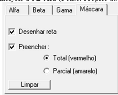
Figura 27 – Campos para entrada dos ângulos e configuração para criação de “máscara” de sombreamento no Analysis-SOL-AR. (Fonte: Próprio autor)
